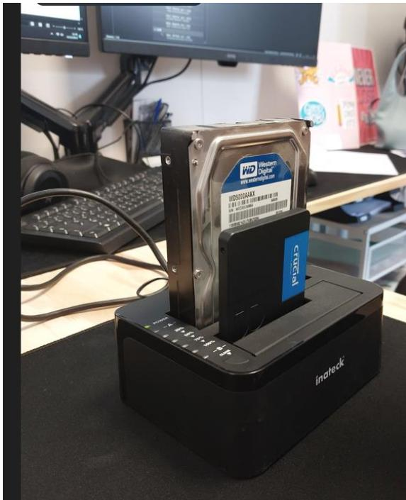
Le vieux disque dur et le nouveau sont branchés à un pc à l'aide d'une station d'accueil pour disques durs et nous n'avons plus qu'à suivre les étapes du logiciel Acronis pour procéder au clonage de l'ancien disque dur.
